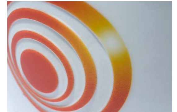
gravierter Druck (Verbindung von Gravur und Siebtransferdruck)
