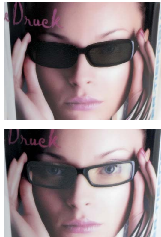
Mit einer Spezialfarbe wird ein aufgedrucktes Motiv partiell abgedeckt. Bei Heißbefüllung wird die Spezialfarbe transparent und das darunterliegende Motiv sichtbar.
